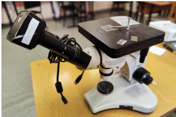
Загальний вигляд комплексу досліджень оптичних параметрів тонких плівок
