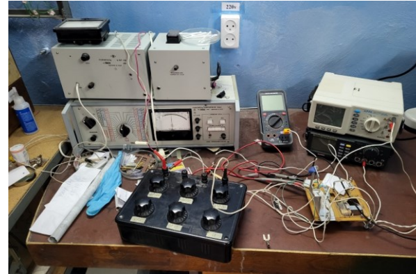
Експериментальний стенд для дослідження фотовідгуку тонкоплівкових структур
